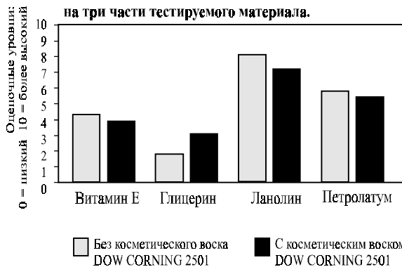
Рисунок 7: СКОЛЬЖЕНИЕ - 1 часть косметического воска DOW CORNING 2501 на 3 части тестируемого материала.
